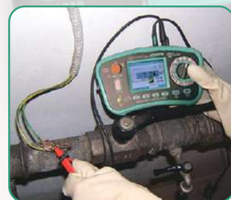
Continuity check of equipotential bonding
